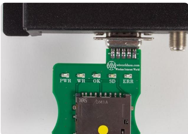
Der Updatevorgang ist nun abgeschlossen. Schalten Sie das Steuergerät aus und entfernen Sie den SD-Programmer. Das Steuergerät kann jetzt wieder wie gewohnt in Betrieb genommen werden.
