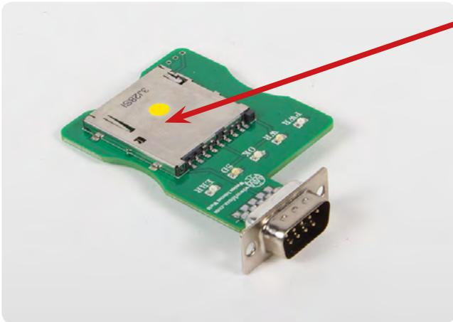
1. Laden Sie die aktuelle Firmware von unserer Homepage **www.megasat.tv** herunter. Die Firmware finden Sie unter Downloads der jeweiligen Antenne. Entpacken Sie das ZIP-Archiv und kopieren Sie die neue Firmware (pop\_main.hex) auf eine SD Karte. Stecken Sie diese anschließend in den SD Programmer.
