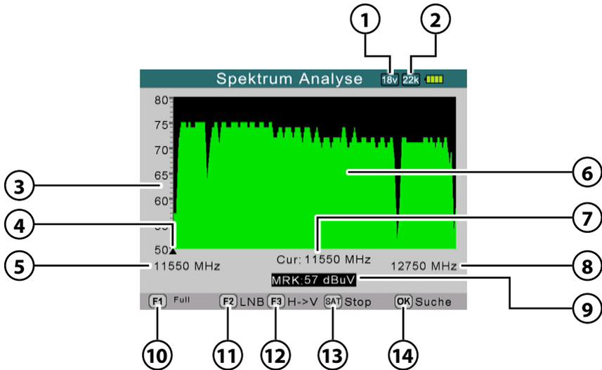
1. Zeigt die aktuelle Spannung den LNBs. Die Werte sind: 13V, 18V oder AUS.
