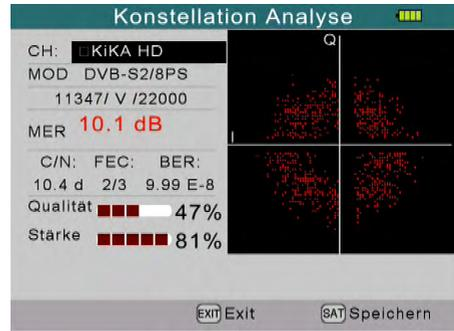
Bei „Analyse nach Programm“ werden die voreingestellten Sender ausgewählt.
