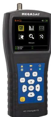
Das HD 3 Kompakt V3 ist ein handliches Messgerät und bestens für eine schnelle und genaue Satelliten-Suche geeignet. Möglich ist die Messung von DVB-S- und DVB-S2-Signalen. Das eingebaute Display hat eine Diagonale von 2,7 Zoll (6,9 cm). Um Ihnen eine schnelle Fehleranalyse und eine optimale Anpassung der Satelliten-Anlage zu ermöglichen, bietet die integrierte Spektrum- und Konstellationsanalyse eine exakte Auswertung der Messdaten.
