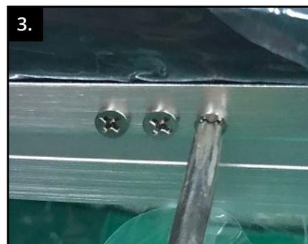
3. Schrauben Sie an der Unterseite des Displays alle Kreuzschlitzschrauben (12 Stk.) heraus.
