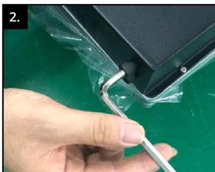
2. Schrauben Sie an der Unterseite des Displays alle Inbusschrauben (10 Stk.) heraus.
