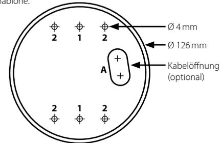
**Hinweis:** Das Bohrloch der Kabelöffnung ist nur erforderlich, wenn der Auslass zum Verlegen des Kabels verwendet wird.
