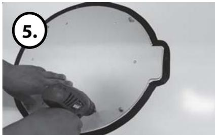
Legen Sie die Platte auf und bohren Sie die 6 Löcher mit einem 2mm Bohrer.
