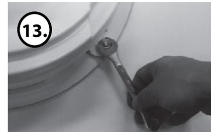
Befestigen Sie die Antenne auf der Montageplatte
