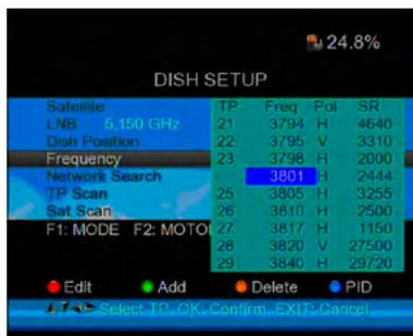
**Hinzufügen:** Drücken Sie die **GRÜNE (H/V)** Taste um eine Frequenz hinzuzufügen, nutzen Sie dazu die Zifferntasten. Drücken Sie die **▼▲** Tasten um die Polarisation zu ändern. Drücken Sie OK um zu Bestätigen und zu speichern.
