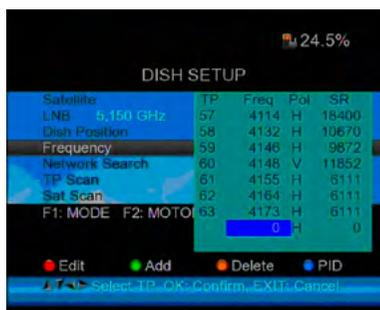
**Löschen:** Drücken Sie die **▼▲** Tasten um eine Frequenz auszuwählen, die Sie löschen möchten. Drücken Sie die **GELBE (AN/DG)** Taste um sie zu löschen. Es erscheint ein Fenster indem Sie mit OK die Löschung bestätigen, oder mit Exit die Löschung abbrechen.
