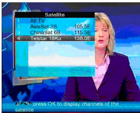
Wählen Sie den Satelliten aus und drücken Sie OK. Die Kanalliste von diesem Satelliten wird nun auf dem Bildschirm angezeigt.
